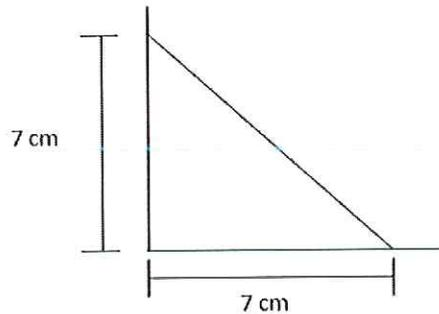
Sur les toitures non isolées avec support en maçonnerie, le chanfrein est réalisé en mortier de ciment.
